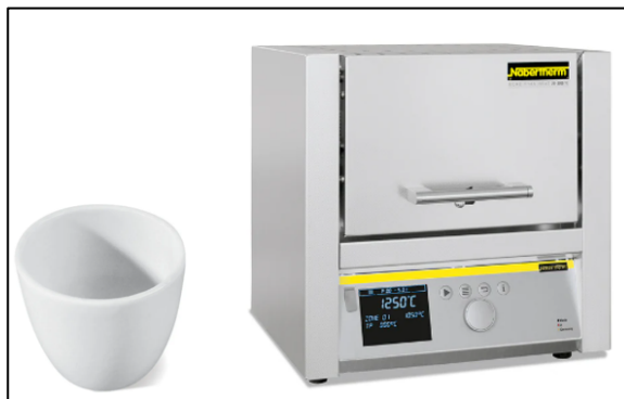
Figura 8.11. Echipamentele utilizate pentru determinarea conținutului de cenușă (creuzet și cuptor de calcinare)
