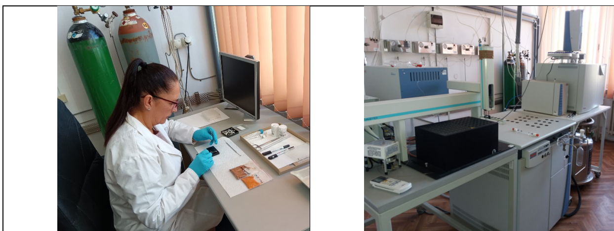
Figura 6.4. Pregătirea capsulelor cu probe și determinările cu spectrometrul de masă Delta V Advantage
