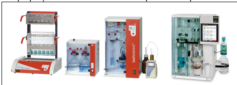
Figura 8.9. Echipamentele utilizate pentru determinarea conținutului de proteine
