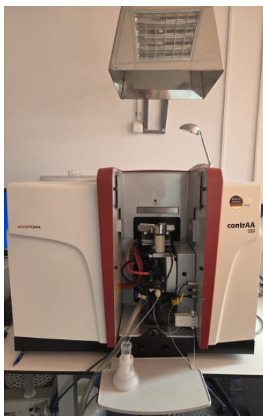
Figura 6.2. Spectrometrul ContraAA 800D de absorbție atomică în flacără utilizat pentru determinarea conținutului elemental.
