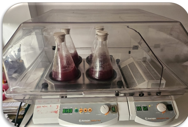
Figura 11.4. Realizarea extracțiilor la flacoane de 500 ml, cu volum util de 300 ml
